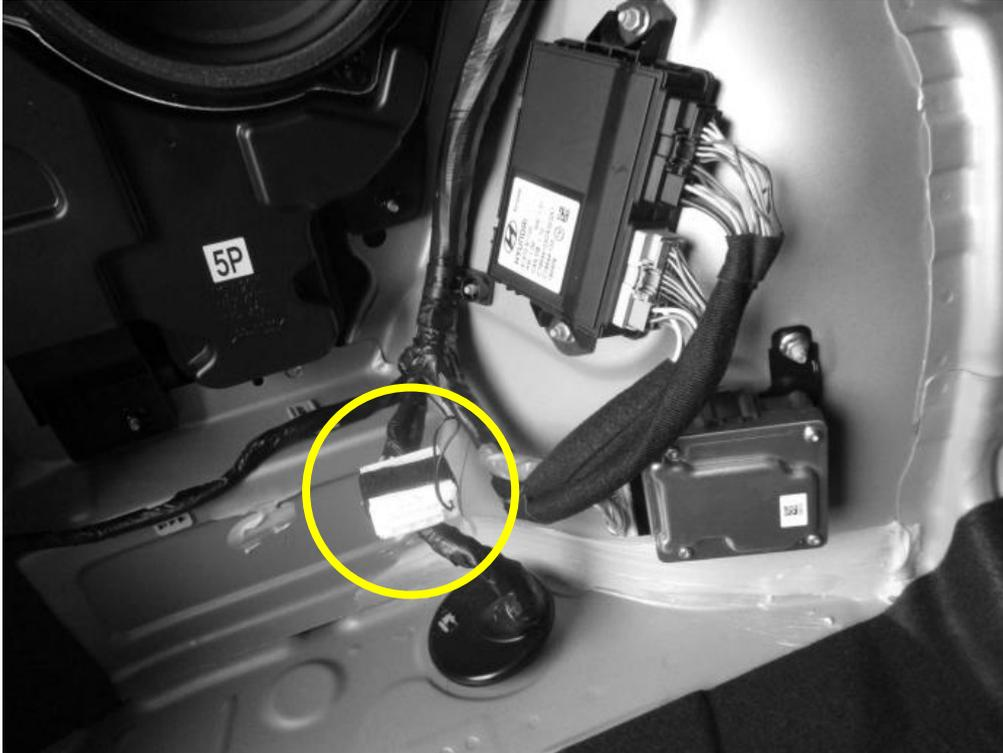
Das Anhängersteuermodul ist mit den beiden Anhängersicherungen 2 und 3 (15A) im Sicherungskasten im Motorraum abgesichert.
