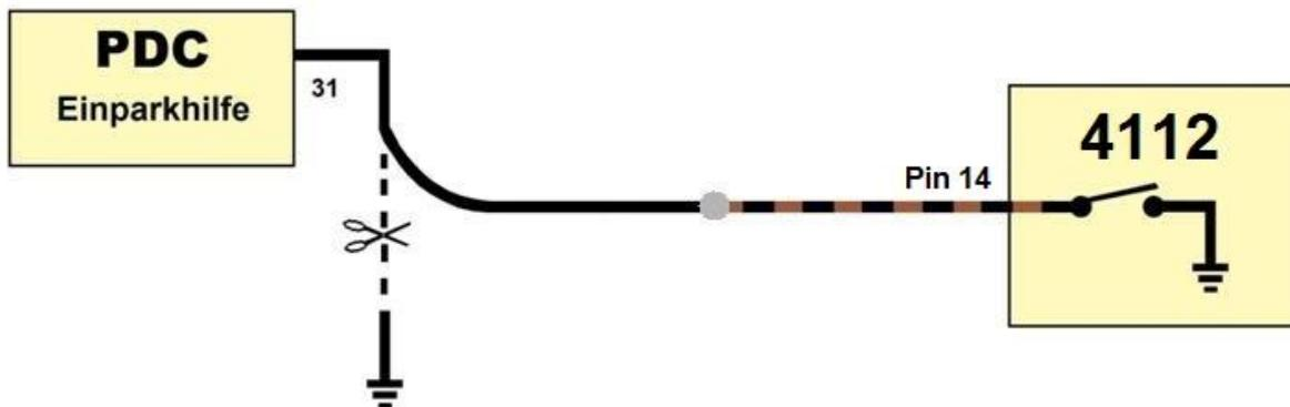
Gegebenenfalls muss ein PDC-Modul mit Metallgehäuse isoliert montiert werden!
