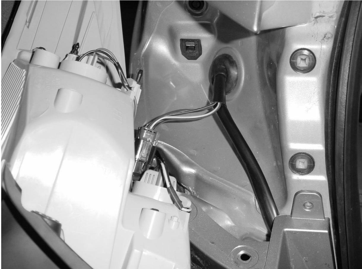
Den fahrzeugseitigen Heckleuchtenstecker mit der Tülle ins Fahrzeuginnere führen. Durch die Öffnung den linken Leitungsstrang mit 24- pol., 3- pol., 6- pol. Stecker und den beiden Masseleitungen usw. nach innen führen. Dabei mit dem 24 pol. Sockel beginnen.
